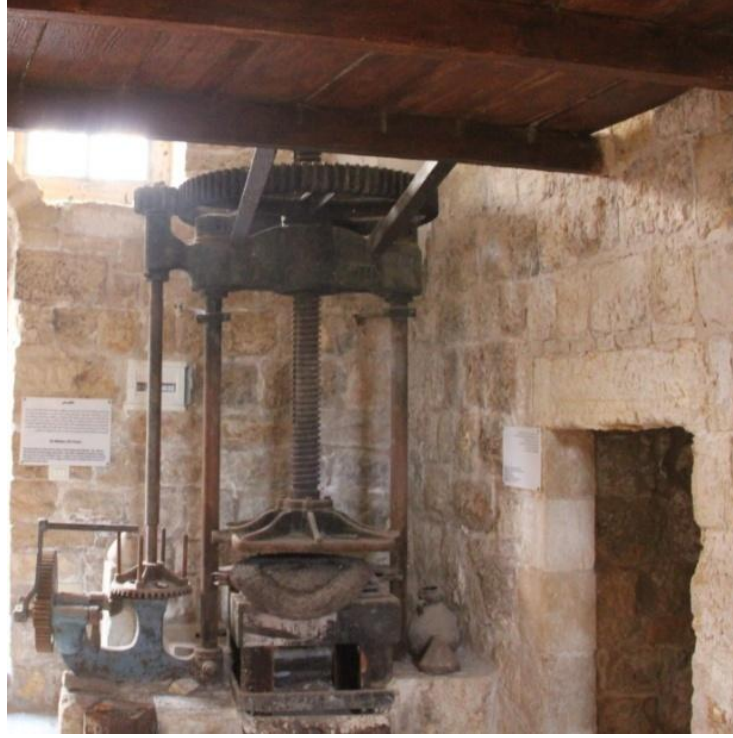
شكل رقم (46): المكبس اللولبي الفولاذي في معصرة جقمان 1
