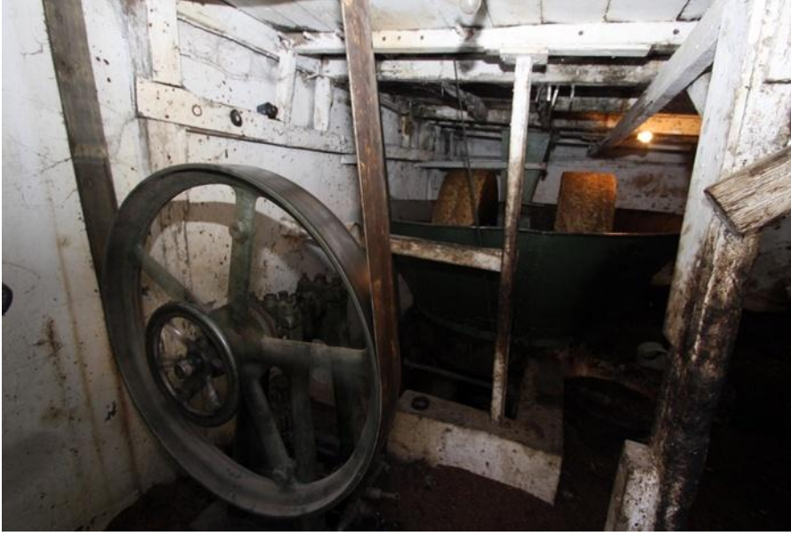
شكل رقم (11): صورة الدولاب الذي كان يقوم بإدارة حجري الدرس في معصرة شهوان 1
