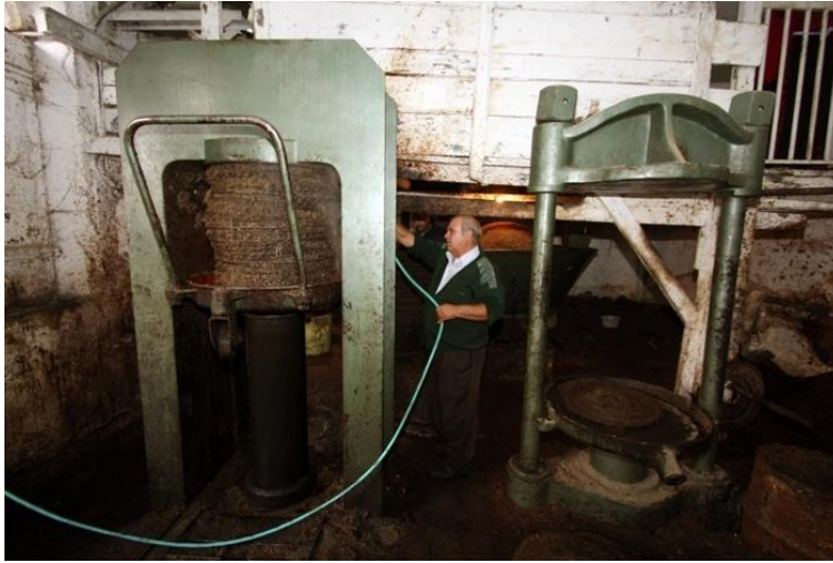
شكل رقم (66): صورة تبين مكابس عصر الزيتون التي كانت تعمل بنظام الهيدروليكي في معصرة شهوان 2
