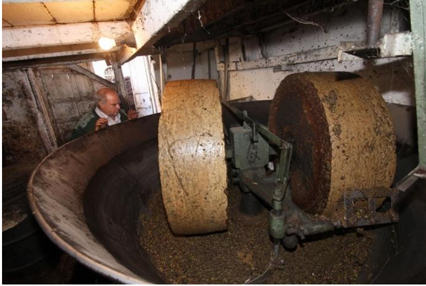
شكل رقم (64): صورة تبين عملية درر الزيتون في معصرة شهوان 1
