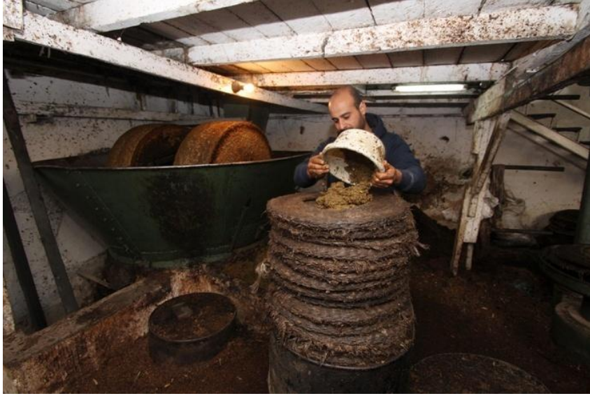
شكل رقم (65): صورة تبين كيفية تعبأة الزيتون المدروس في قفف لوضعها تحت المكبس في معصرة شهوان 1
