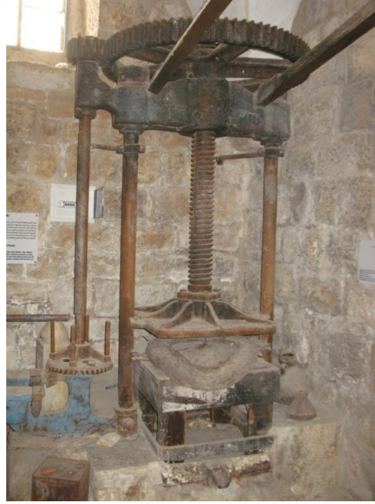
شكل رقم (53): المكبس اللولبي الفولاذي في بد جقمان 2
