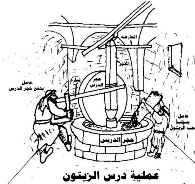
شكل رقم (49): رسم توضيحي يبين عملية دوران حجر الدرس في المعصرة بواسطة الإنسان 2
