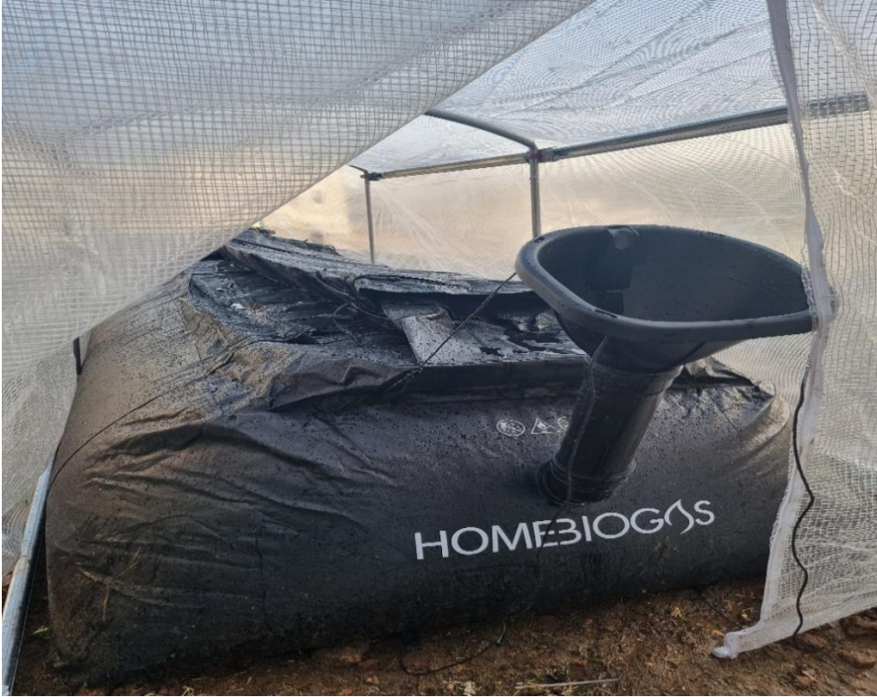
شكل 2.1: نظام إنتاج الغاز الحيوي كنموذج من تنفيذ مؤسسة الهيدرولوجيين في مدرسة المستقبل / البيرة
