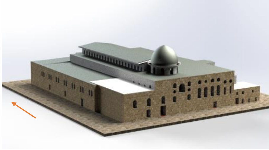
لوحة رقم 99: مجسم الجامع الأقصى من الخارج، ويظهر توزيع النوافذ في الواجهتين الجنوبية والغربية، رأس السهم يشير الى الشمال. مصدر اللوحة: المهندس محمد صلاح والباحث
