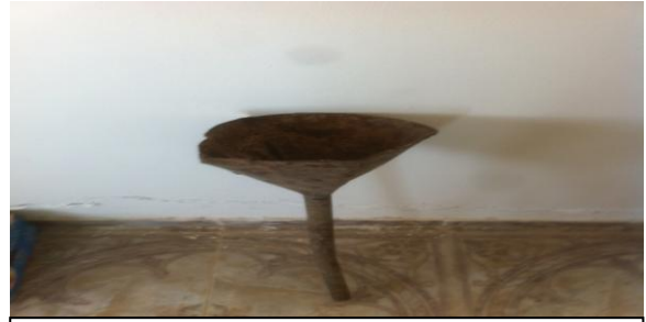
شكل رقم 32: محقان يُستخدم في تلقيط (بذار) السمسم أو العصفور مصنوع من الحديد.
