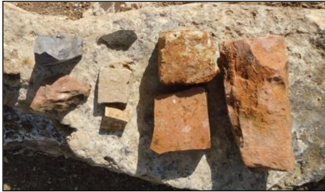
الشكل 4:53 مراحل قص الحجارة وتحضير مكعبات الفسيفساء. (المصدر): الباحث، 2013.
